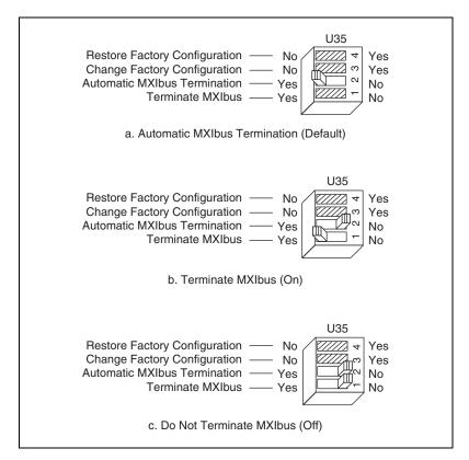
Figure 3-9. MXIbus Termination
